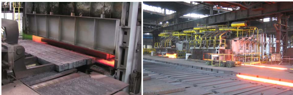
Obr. 6.39. Průběžné ohřívací pece HCC tratě, vlevo vstupní strana, vpravo pohled od 9. stolice
