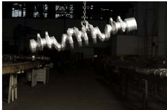
Obr. 7.65. Velké zápusťkové výkovky CPF vlevo: turbínové lopatky, vpravo: kliková hřídel
