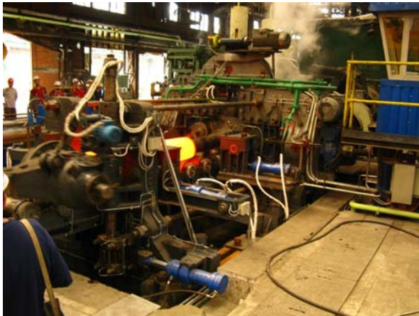
Obr. 6.35. Děrovací stolice – pohled zepředu
