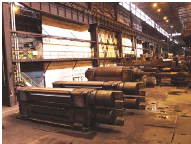
Obr. 6.57. Pár pracovních válců s ložisky připravený k výměně
