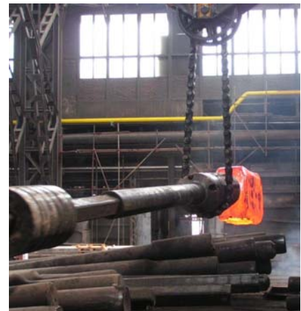
Obr. 7.48. Transport výkovku do pece (Vítkovice Heavy machinery)
