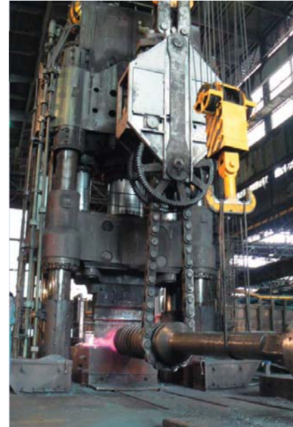
Obr. 7.53. Vítkovice – lis 120 MN, před rekonstrukcí v roce 2008
