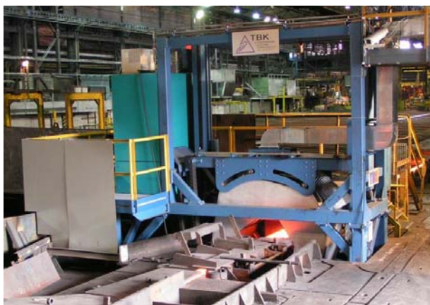
Obr. 6.3. Zařízení pro měření rozměrů kolejnic za tepla (TBK)
