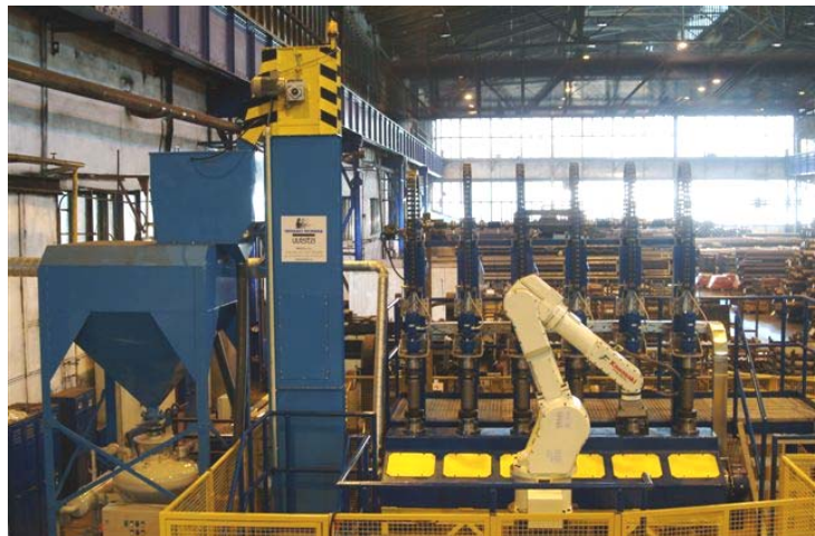
Obr. 8.35. Výroba lahví z trubek . výrobní linka
