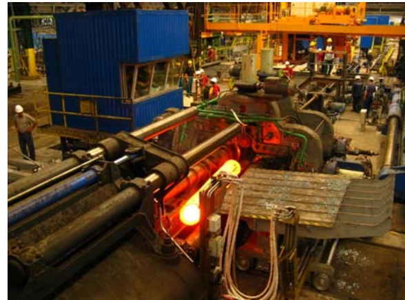
Obr. 6.36. Děrovací stolice – pohled zezadu
