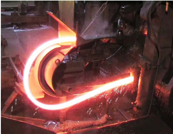
Obr. 6.76. Smyčka za trio stolicí předválcovacího pořadí PP1.
