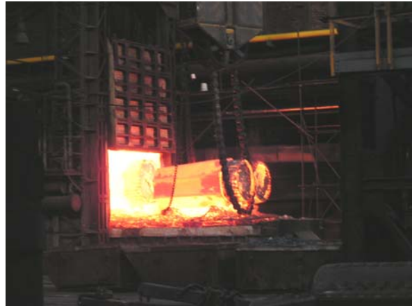
Obr. 4.33. Pec s výjezdnou nístějí- Vítkovice Heavy Machinery
