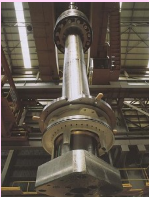
Spojení pístu (nahore) a pístnice. Čtvercová deska dole slouží k připojení ke křížové hlavě.
