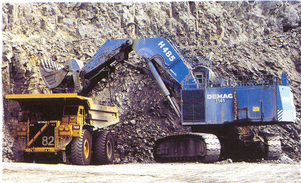
Obr.1.32. Obří nakladač DEMAG. Lžice musí být velmi odolná proti opotřebení, celá konstrukce musí být zároveň velmi pevná.
