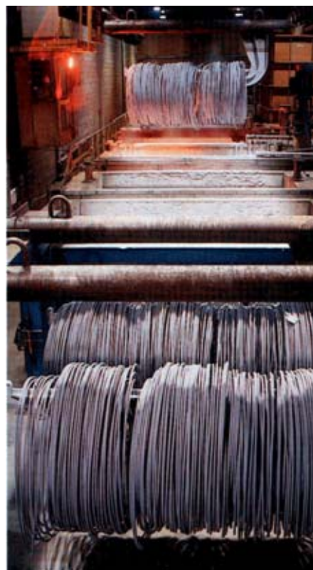
Obr. 8.6. Pohled na linku pro moření svitků drátů – operace vápnění.
