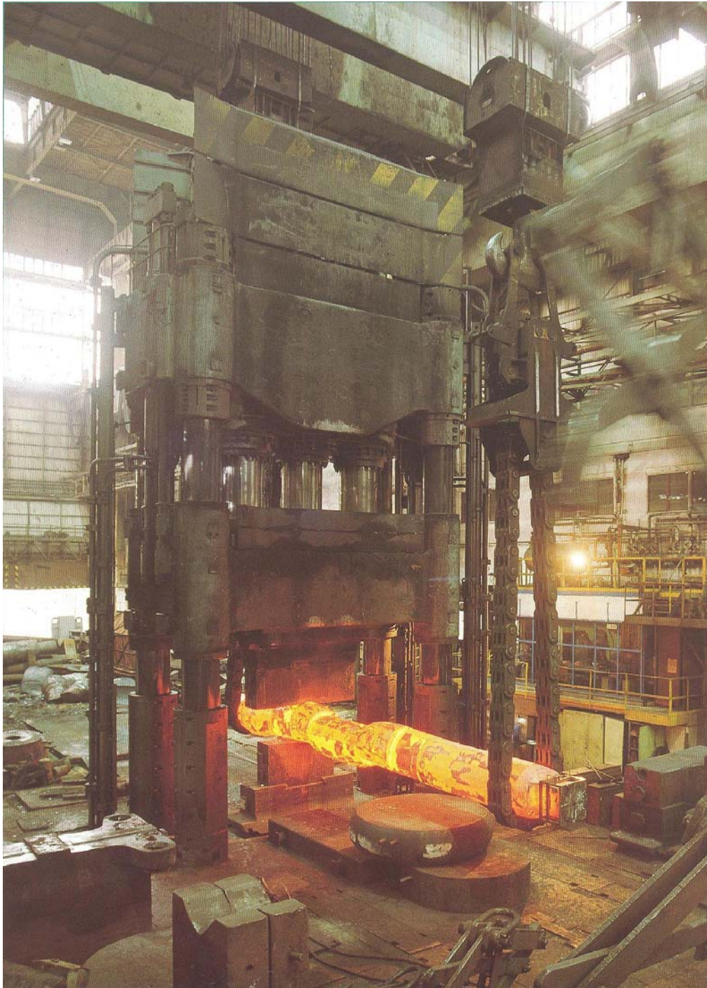
Obr. 7.62. Kovací lis CKV 105 MN, Pilsen Steel, s.r.o., kování klikové hřídele pro čtyřdobý motor
