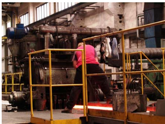
Obr. 6.28. Ruční manipulace s provalkem
