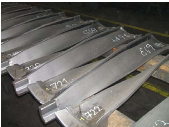
Obr. 7.65. Velké zápusťkové výkovky CPF vlevo: turbínové lopatky, vpravo: kliková hřídel
