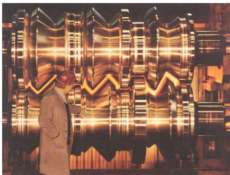
Obr. 1.15. Kalibrované válce se třemi kalibry pro výrobu Z štětovnic
