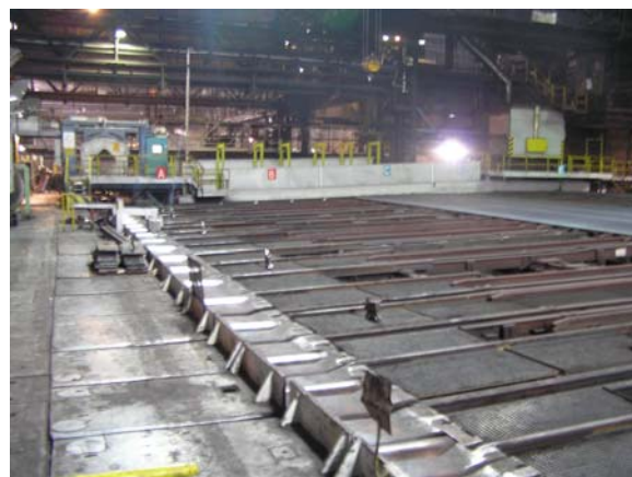
Obr. 6.4. Chladicí lože, vlevo vzadu zařízení TBK
