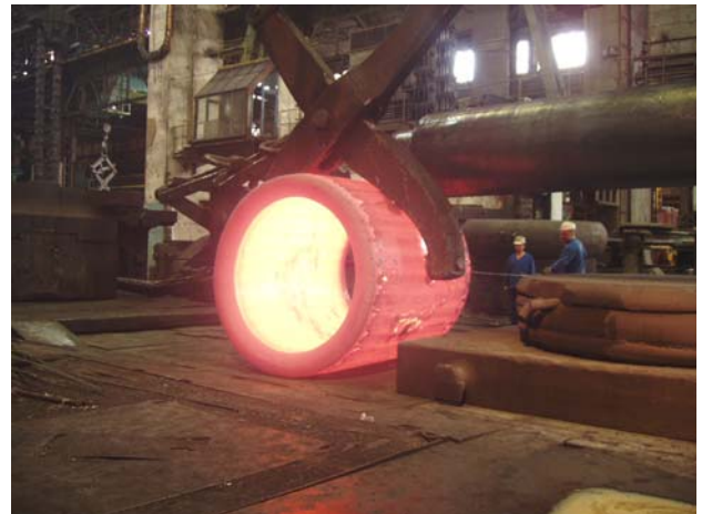
Obr. 7.64. Kování kotle – redukce tloušťky stěn, kterému předcházelo děrování viz. obr.7.24.
