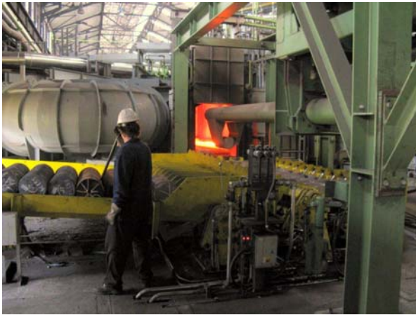
Obr. 6.33. Karuselová pec-sázení polotovaru do pece
