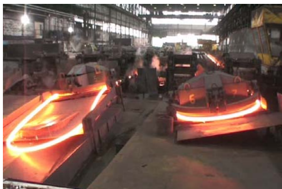
Obr. 6.78. Smyčky mezi stolicemi hotovního pořadí HP4-HP5 a HP6-HP7
