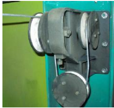
Obr.8.8. Příklad konfigurace ohýbacích kladek
