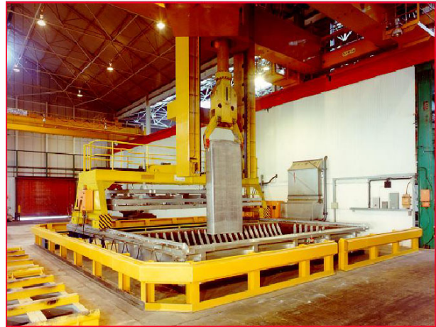
Obr. 4.23. Hlubinná pec s manipulátorem
