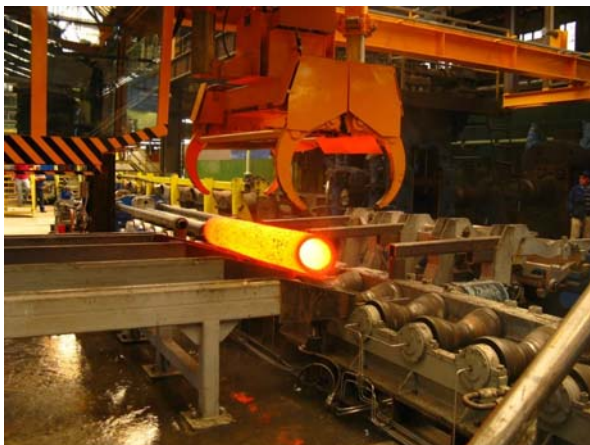
Obr. 6.37. Přeprava tlustostěnné trubky k poutnické stolici
