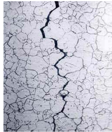
Obr. 4.14. Šíření trhliny po hranici zrna
