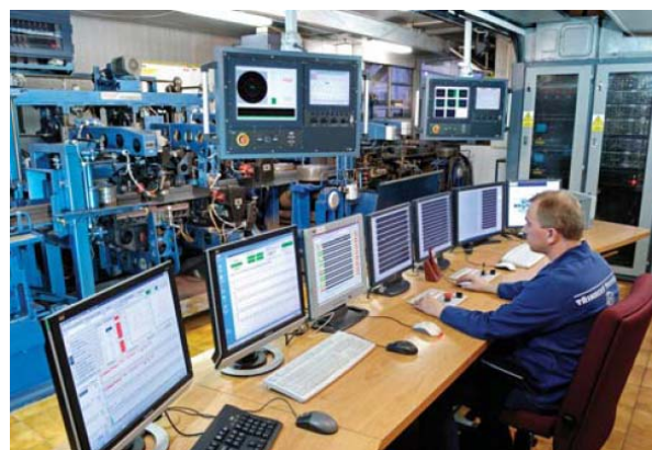
Obr. 6.6. Kontrola rozměrů a defektoskopie
