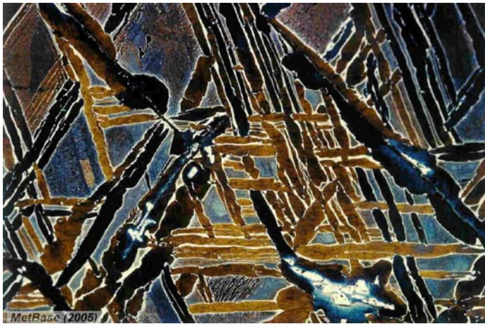
Obr. 4.13. Widmannstättenova struktura, ostré jehlice výrazně zhoršují tvařitelnost za studena
