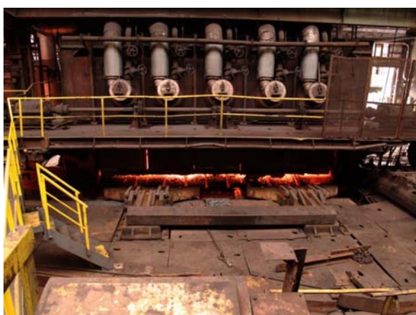
Obr. 6.65. Výstupní strana strkací pece
