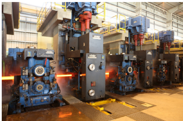
Obr. 5.29. Přípravné pořadí –HV stolice (Emirates steel)
