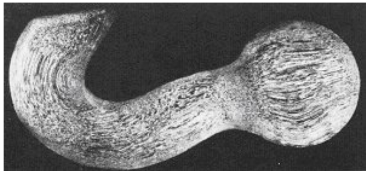
Obr. 7.7. Makrostrukturní snímek řezu výkovku háku s dobře rozpoznatelnou vláknitostí
