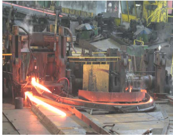
Obr. 6.77. Stalice předválcovacího pořadí PP1 a PP2, zadní konec provalku je před stolicí PP1, přední konec už prošel stolicí PP2
