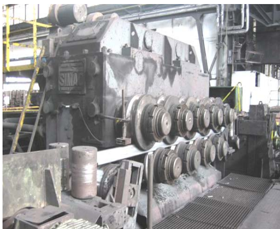
Obr.6.43. Válečková rovnačka SIMAC k rovnání profilových tyčí
