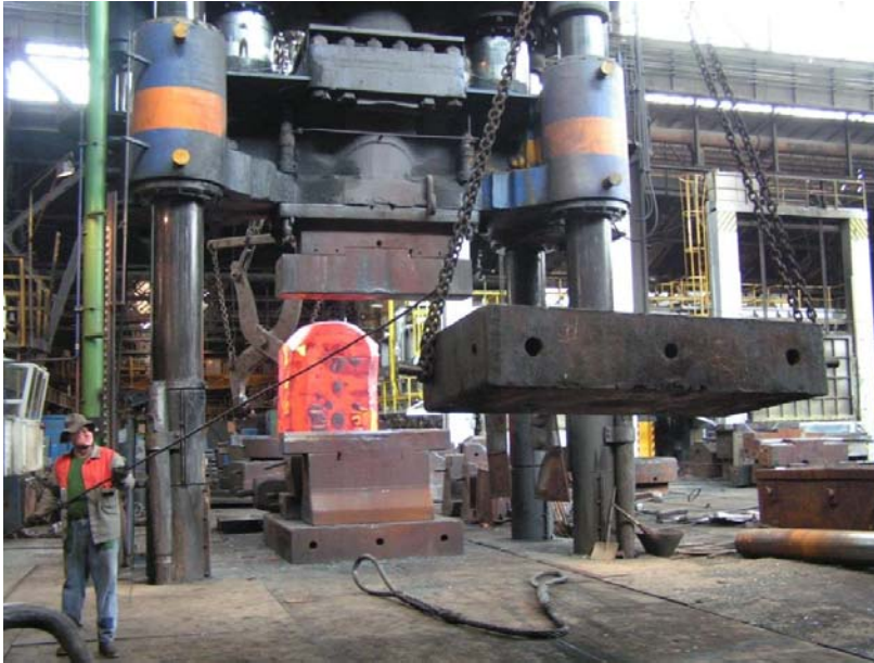
Obr. 7.52. Vítkovice – lis 60 MN, příprava operace pýchování
