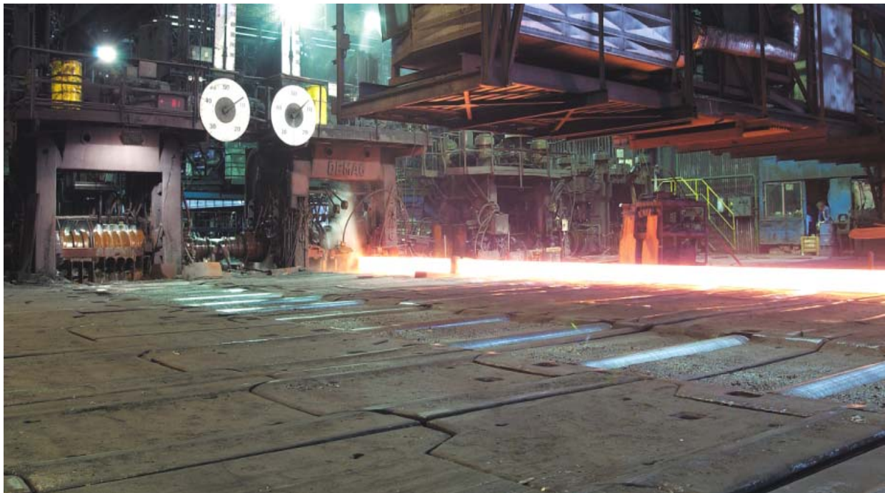
Obr.6.2. Vratná trať pohled na stolice od blokovny, vlevo stolice pro válcování sochorů
