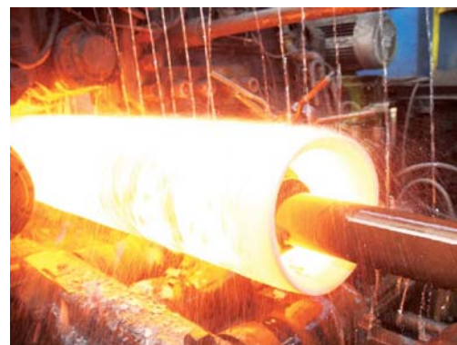
Obr. 5.57. Výstup z děrovací stolice
