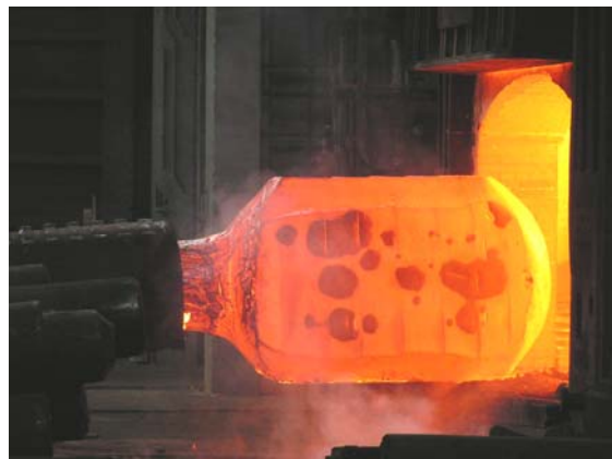
Obr. 4.31. Pec o vodorovnou nístějí - Vítkovice Heavy Machinery
