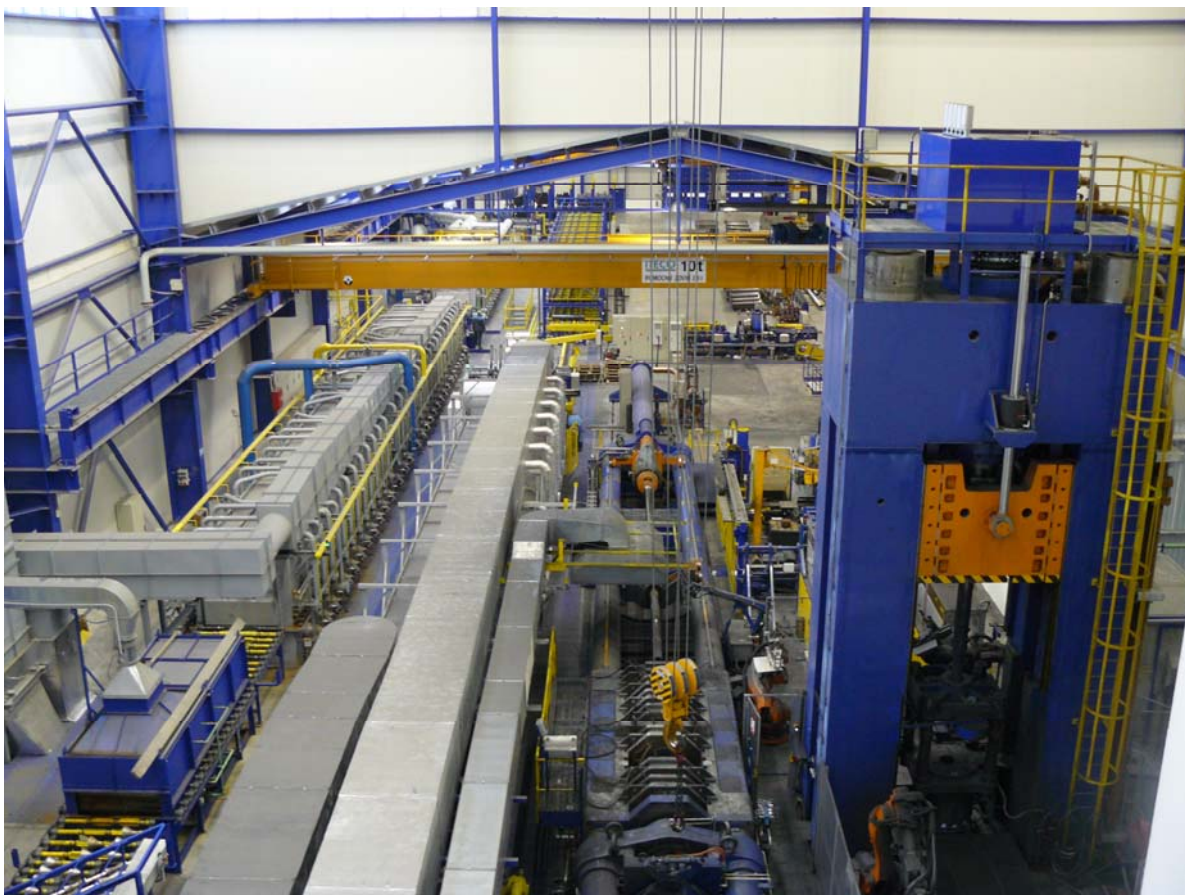
Obr. 8.34. Výroba ocelových lahví protlačováním
