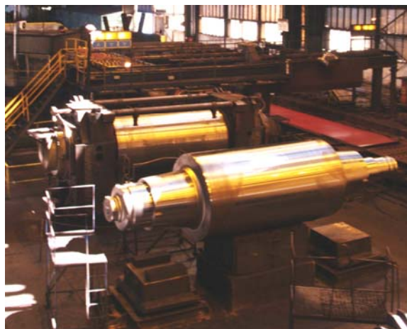
Obr. 6.58. Opěrné válce, vepředu odstojený válec, vzadu válec s ložisky a chladicími tryskami
