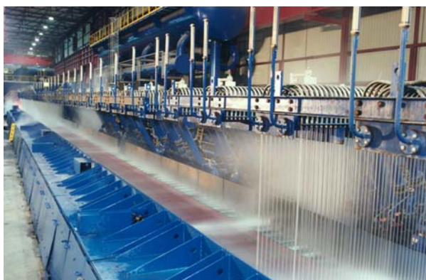
Obr. 5.51. Laminární chladicí sekce
