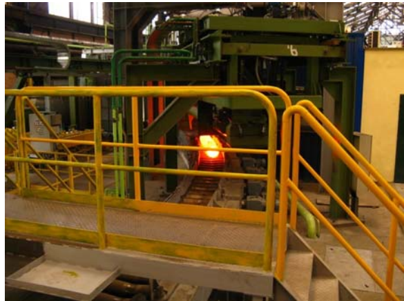
Obr. 6.34. Doprava polotovaru k děrovací stolici
