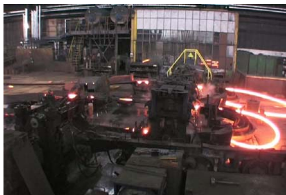
Obr. 6.79. Stolice hotovního pořadí HP7 (na snímku vlevo dole) a HP6 až HP3 (na snímku uprostřed v zákrytu), smyčky vlevo jsou mezi stolicemi HP3-HP4 a HP5-HP6
