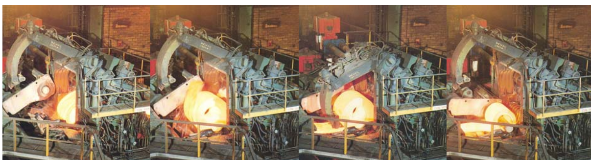
Obr. 5.44. Práce Coilboxu, zleva do prava: začátek vytváření svitku, konec vytváření svitku, přetočení svitku, odvíjení svitku
