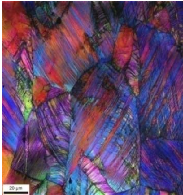
Obr.1.49. Mikrostruktura TWIP oceli, v austenitickém zrně jsou jasně patrná deformační dvojčata
