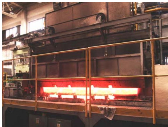
Obr. 6.27. Výstup polotovaru z pece
