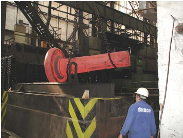
Obr. 7.63. Kalení hřídele větrné elektrárny
