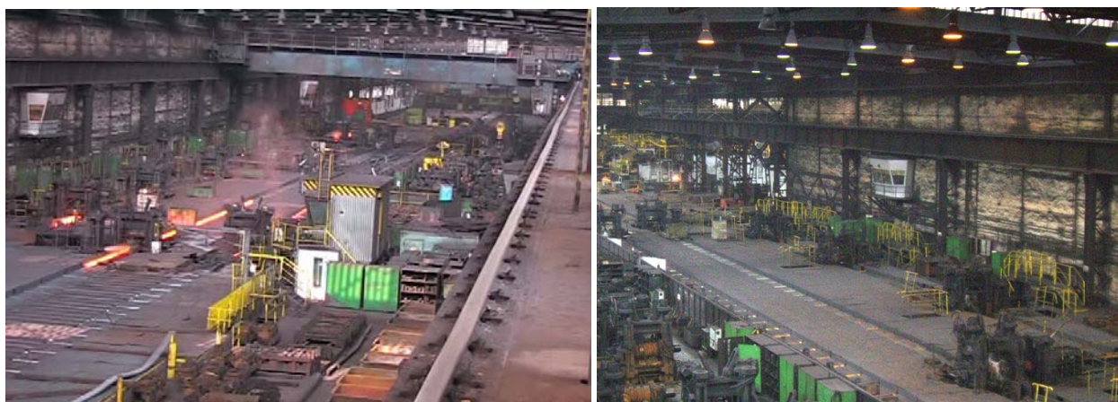
Obr. 6.40. Pohled na přesazené uspořádání válcovacích stolic tratě HCC
